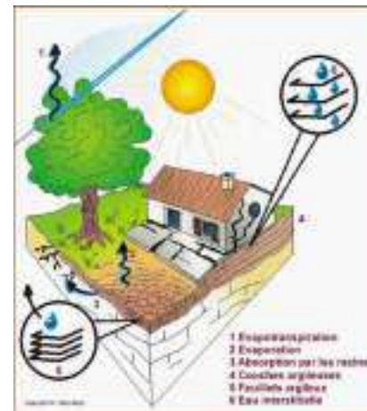
FIGURE 32. SCHEMA ILLUSTRANT LE PHENOMENE DE RETRAIT-GONFLEMENT DES ARGILES ET SES CONSEQUENCES SUR LE BATI (SOURCE : BRGM)
