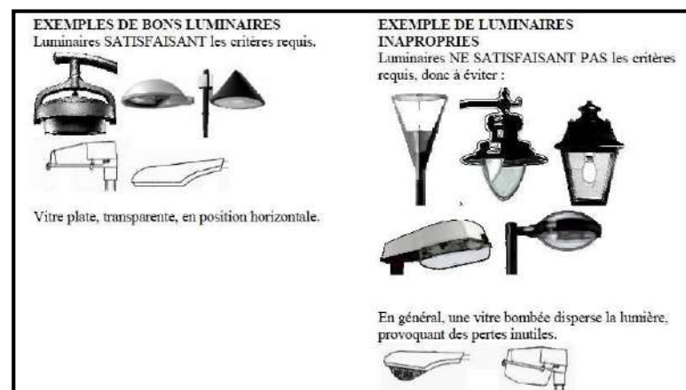
Figure 33 : Types de luminaires (source : CCTP Eclairage public, ANPCEN 2008)
